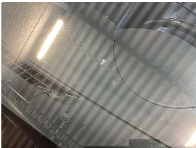
1.9 Steinsprut i frontrute föreside
