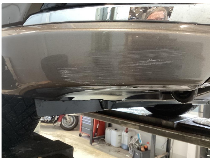
1.7 Skade/riper stötfanger foran höyre side
