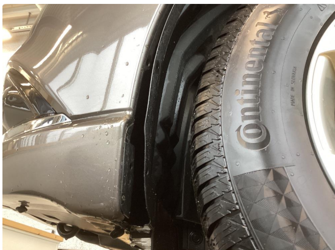
1.1 Venstre innerskjerm foran er løs og sprekk i bunnplate
