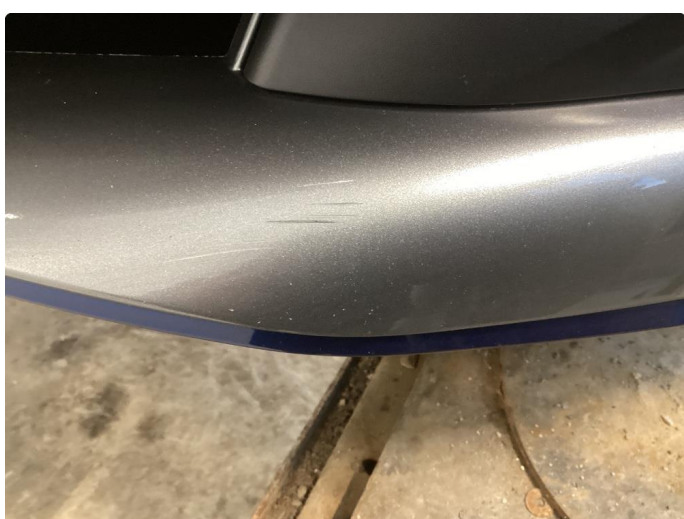
1.4 Hakk/riper i støtfanger foran nedre del.
