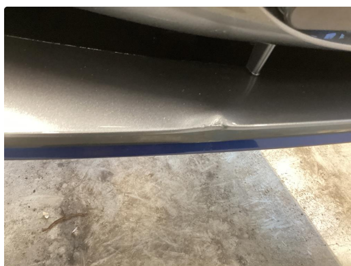
1.4 Hakk/riper i støtfanger foran nedre del.
