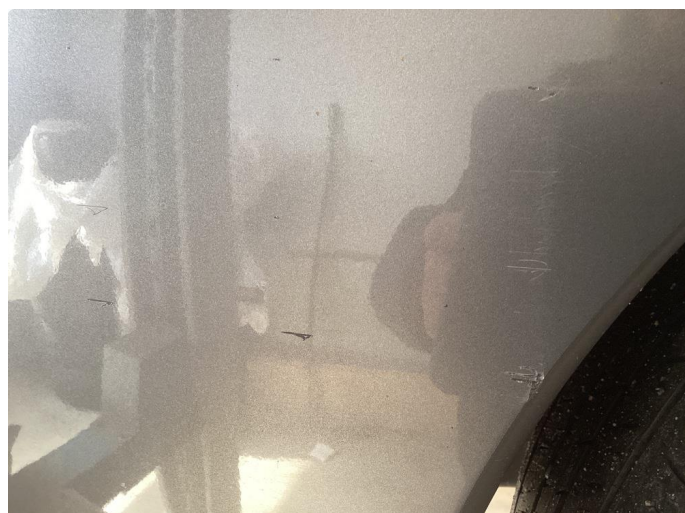
1.3 Riper støtfanger bak høyre side
