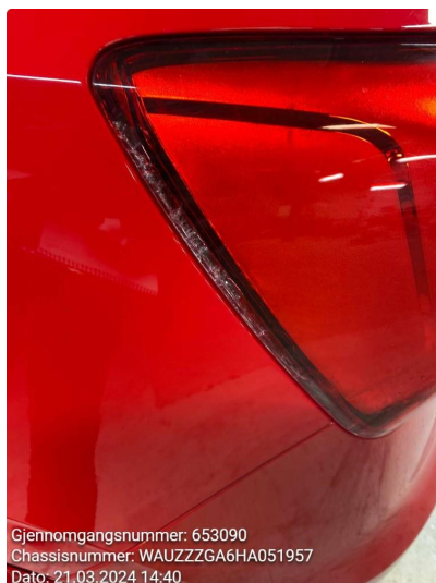
2.1 Krakelering i plast bak
