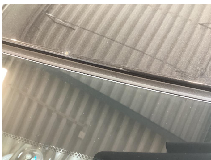
1.4 Rustrose tak over frontrute
