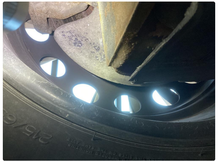
2.1 Rust bremsar bak innside venstre side bak
