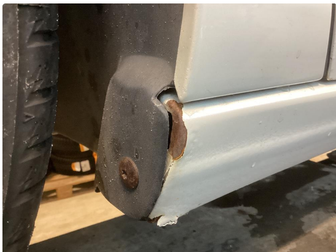
1.6 Rust framkant kanaler begge sider
