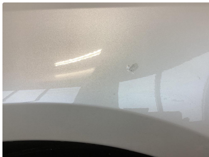
1.2 Knast flekket venstre forskjerm og høyre fordør
