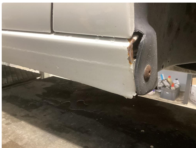
1.6 Rust framkant kanaler begge sider
