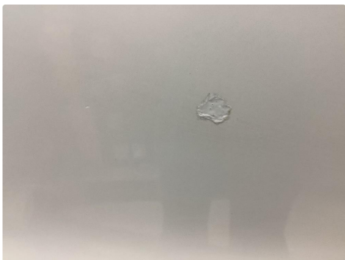
1.2 Knast flekket venstre forskjerm og høyre fordør
