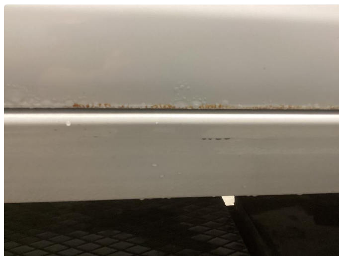
1.3 Rust i bunn høyre fordør
