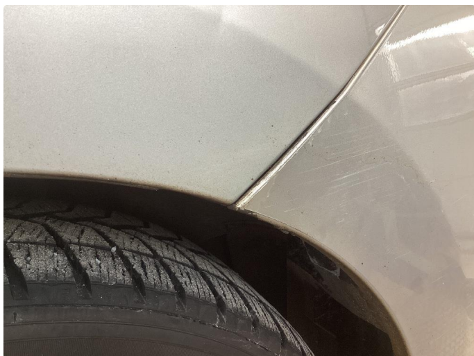
1.3 Noe riper og løs innfestning stötfanger venstre side bak.
