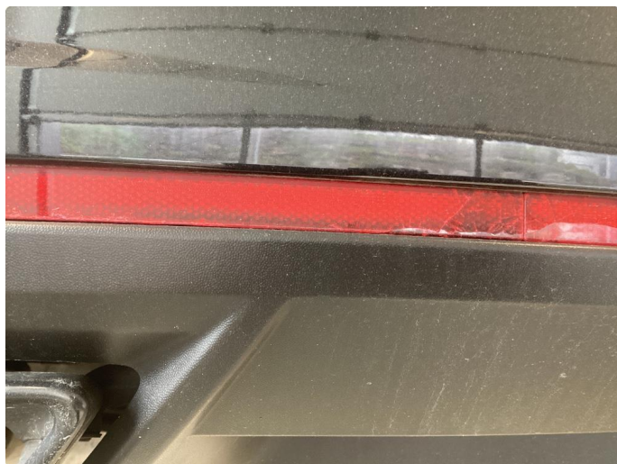
2.7 Lang reflex i stötfanger bak er sprukket/krakkelert
