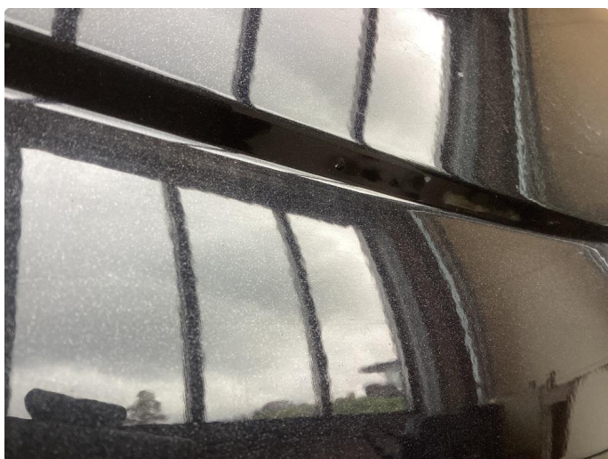
2.4 Noe sinkslipp i dörrer
