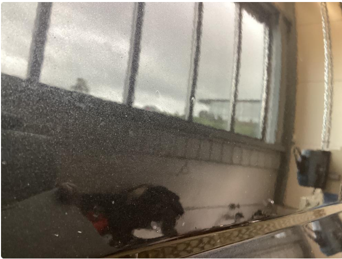
2.2 Venstre forskjerm, bakskjerm og høyre fordör er omlakkert. Mye stöv i venstre fordör
