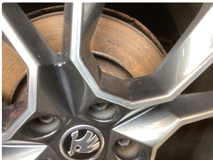
3.1 Påbegynt rust/slitasje på bremsler
