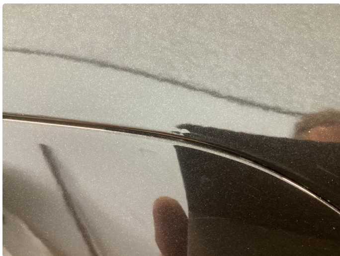
2.5 Påbegynt rust begge bakskjermer
