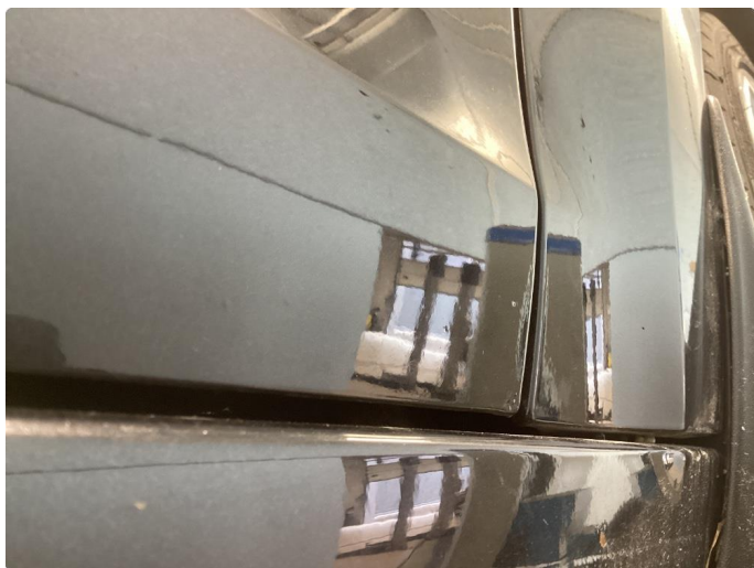
2.4 Noe sinkslipp i dörrer
