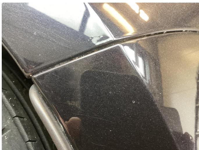
2.5 Påbegynt rust begge bakskjermer
