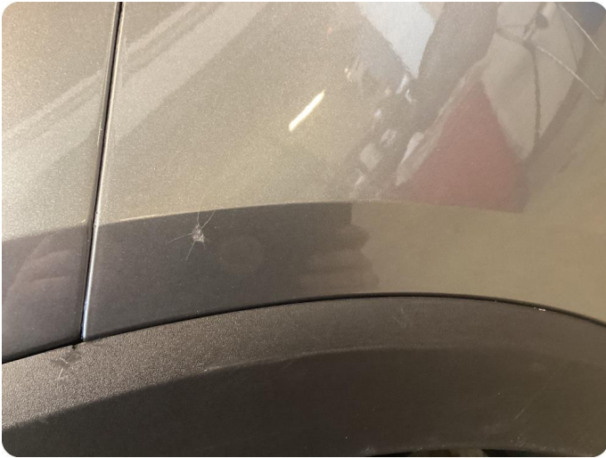
1.1 Ufagmessig utført arbeid Steinsprut høyre side fram
