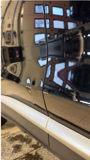
1.1 Parkeringsskade, bulk og stripe
