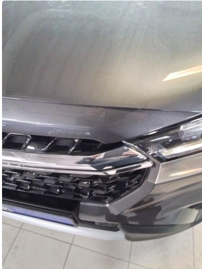
1.1 Små stensprut. Lagt i lakk
