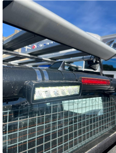
2.1 Dugg i ekstra arbeidslys på taket
