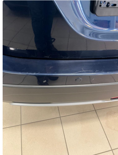
1.2 Små merker etter innlastning. Polert
