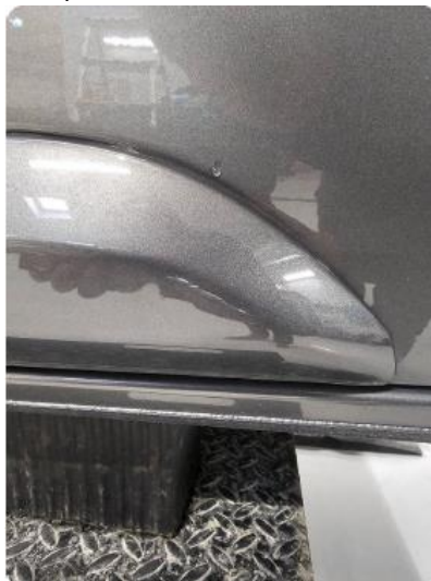
1.1 Riper på nedre del av venstre bak dør og begge front dører.
