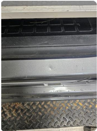
1.5 Små bulker på begge skyvedør og høyre foran døråpning
