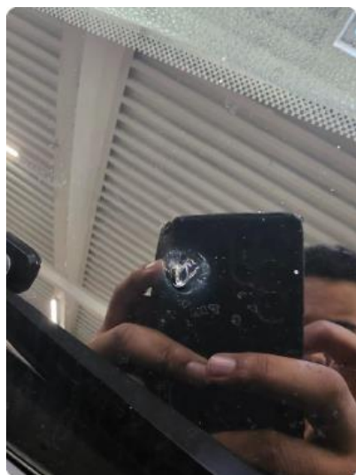
1.9 2 steinsprut merker i frontruta som har blitt fylt
