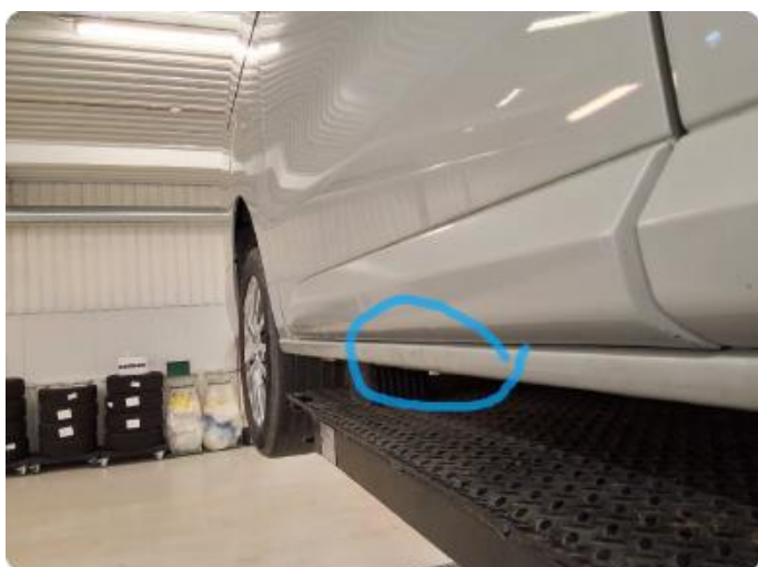
1.5 Små bulker i kanalen begge sider.
