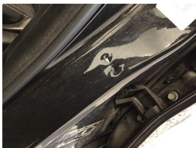
1.4 Bulk(er) med lakkskade
