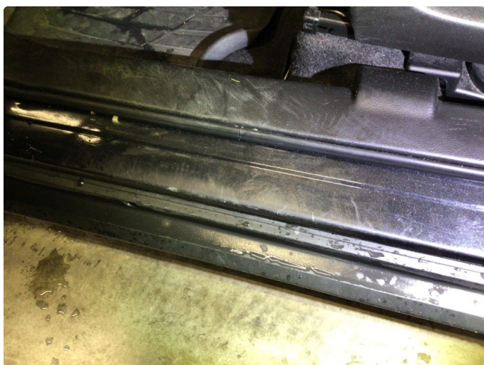
1.4 Bulk(er) med lakkskade
