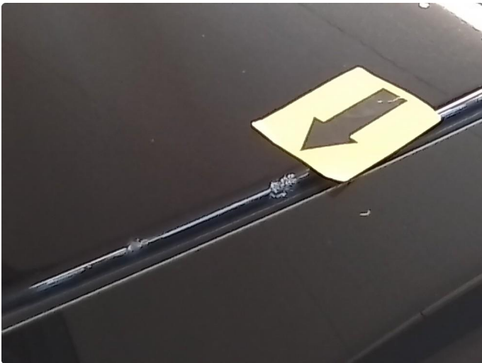
1.1 Steinsprut med rustblemme som burde ses på ved ruteskift
