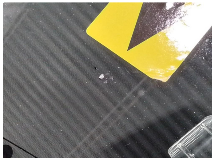
1.4 Steinsprut med sprekk
