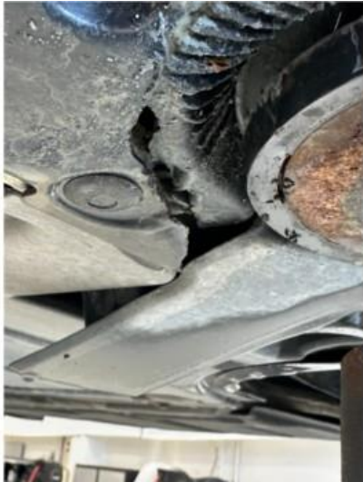
1.1 Noen sprekker i beskyttelsesplate under bilen.
