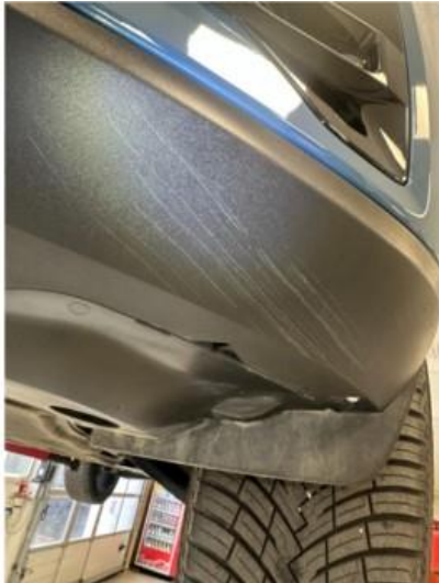
1.1 Litt oppripet på underside av fanger foran
