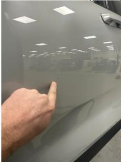
1.1 Liten steinsprut i dør venstre foran
