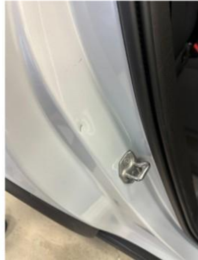
1.4 Liten bulk med lakkskade i døråpning høyre bak
