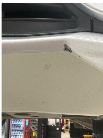
1.3 Litt oppripet på underside av fanger foran. Normal slitasje
