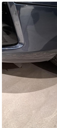
1.2 Litt oppripet på nedre del av fanger venstre foran
