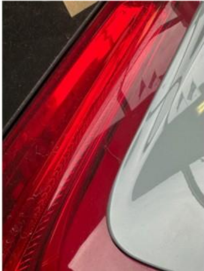
1.1 Lita sprekk i lys høyre bak
