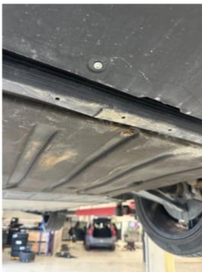
1.3 Liten ubetydelig sprekk i underkant av fanger foran
