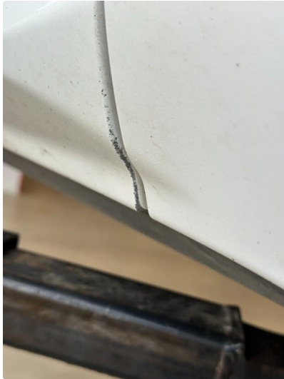
1.1 Noe matt/slitt lakk nedkant begge sider foran. Lakkeres forenklet
