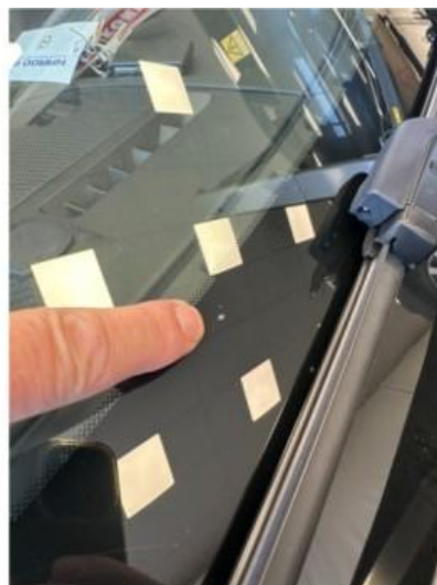
1.2 Liten steinsprut i frontrute utenfor synsfelt
