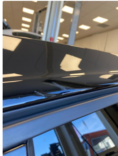
1.4 Noen riper på kant av tak høyre side
