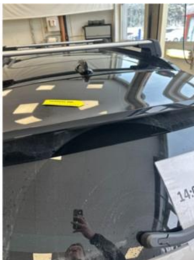
1.1 Liten lakkskade oppe på spoiler på bakluke. Lakkeres forenklet
