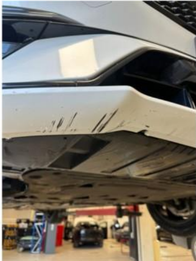
1.1 Litt oppripet på underside av fanger foran
