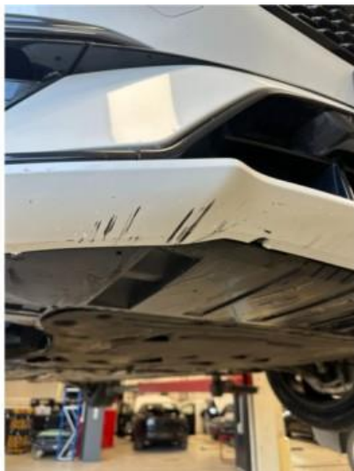
1.1 Litt oppripet på underside av fanger foran
