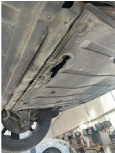
1.1 Lite hull i beskyttelsesplate under bilen.
