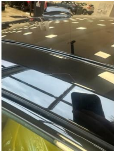
1.1 Ripe på tak høyre side. Dempes med rubbing og polering
