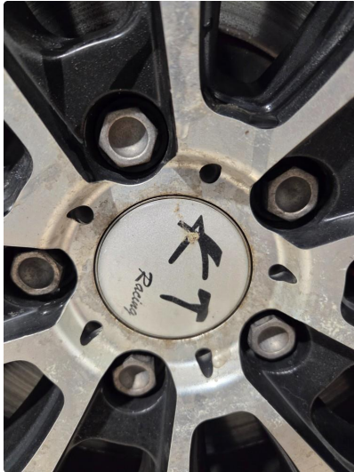
1.2 Noe påbegynnende oksidering på vinterfelger.
