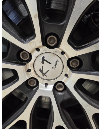
1.2 Noe påbegynnende oksidering på vinterfelger.
