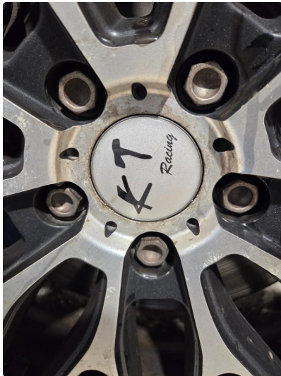
1.2 Noe påbegynnende oksidering på vinterfelger.
