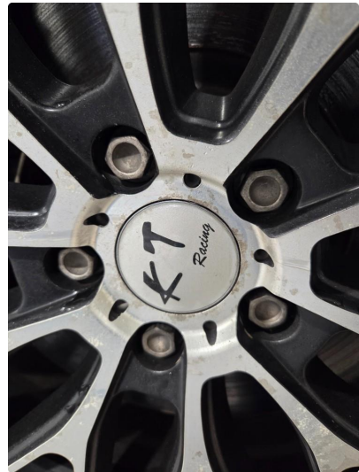
1.2 Noe påbegynnende oksidering på vinterfelger.
