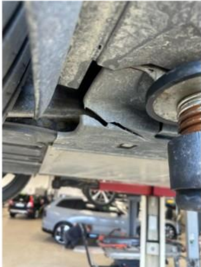
1.2 Sprekk i beskyttelsesplate under bil. Ingen praktisk betydning
