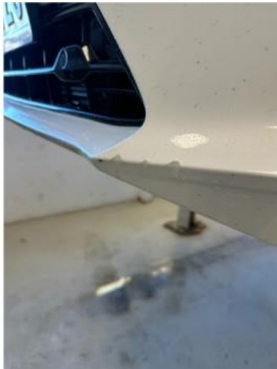
1.1 Noen hakk i nedre del av fanger venstre foran
