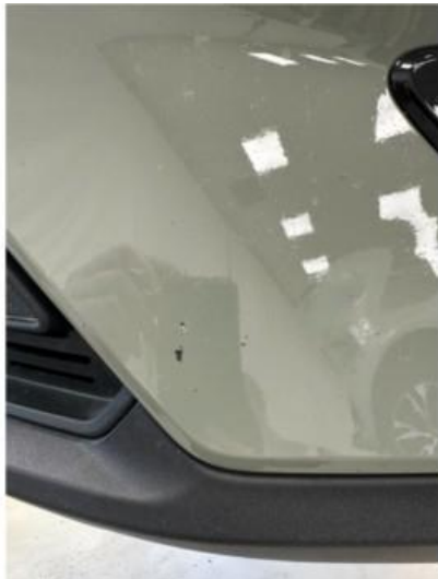
1.3 Noe små steinsprut i fanger venstre foran. Lakkeres forenklet
