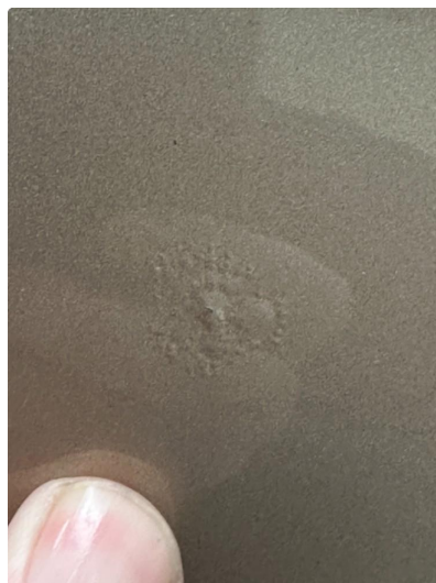
1.1 Litt påbegynnende rust/korrosjon i dør venstre bak
