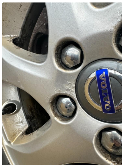
1.2 Noe påbegynnende oksidering på vinterfelger
