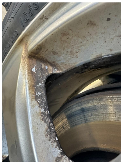
1.2 Noe påbegynnende oksidering på vinterfelger
