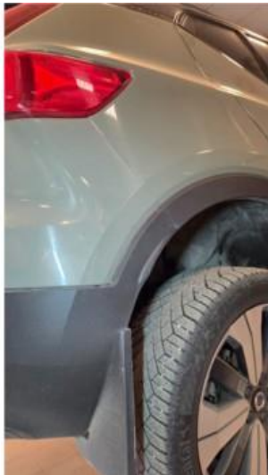
1.1 Liten lakkskade i fanger høyre bak
