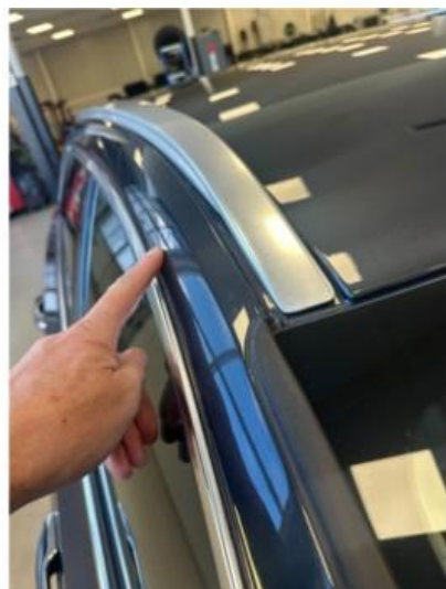
1.4 Liten bulk ved takrails høyre foran
