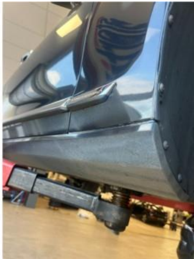
1.6 Kanaler begge sider noe matt. Vil bli ettermontert skvettlapper
