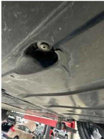
1.1 Liten sprekk i beskyttelsesplate under bil
