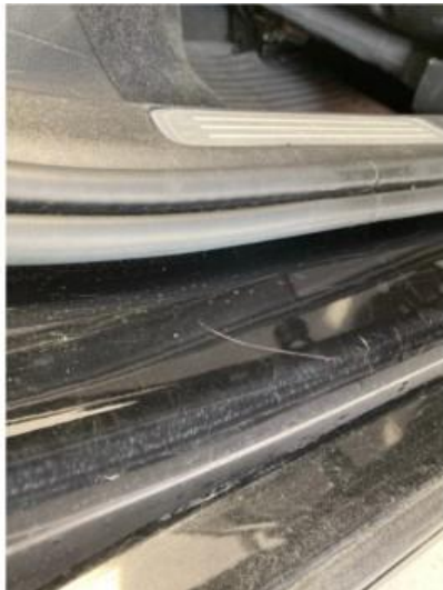
1.1 Riper i døråpning høyre bak
