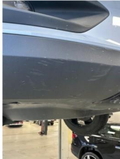
1.2 Litt oppripet på underside av fanger foran. Normal slitasje
