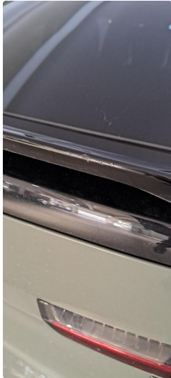
1.1 Liten lakkskade oppe på spoiler bakluke. Høyre side. Lakkert forenklet
