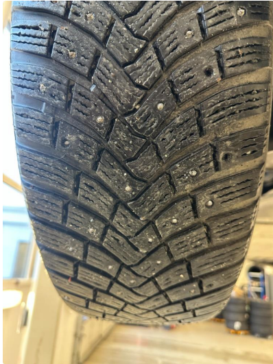
1.1 Piggdekk mangler noen pigger. Dette er innenfor normal slitasje
