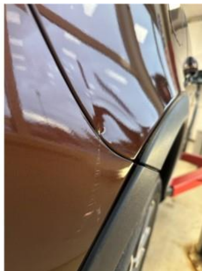
1.2 Bulk med en liten lakkskade i skjerm høyre bak
