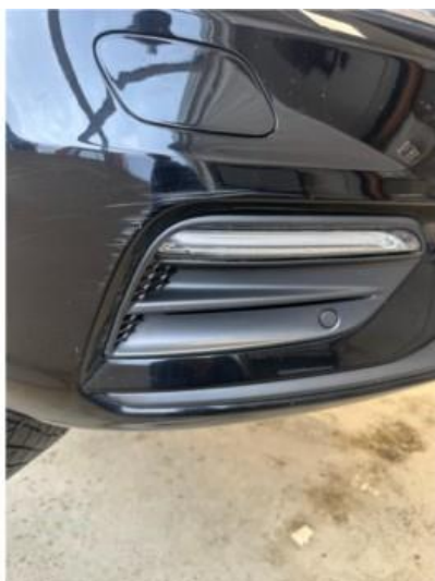
1.3 Noen riper i fanger høyre foran. Dempes med rubbing og polering
