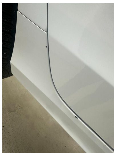
1.2 To små lakksår i dørstokklist høyre bak. Lakkeres forenklet
