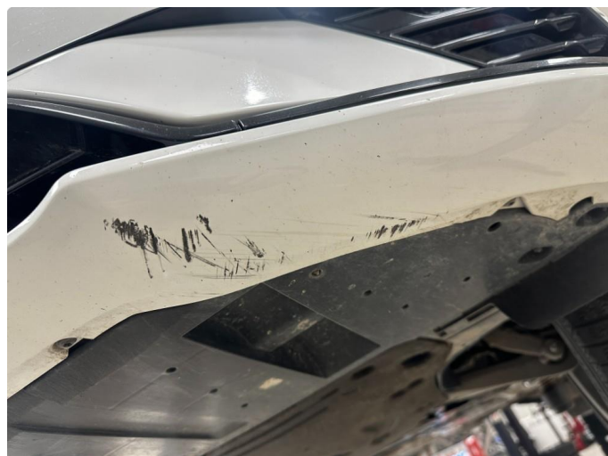
1.1 Noe oppriper på underside av fanger foran
