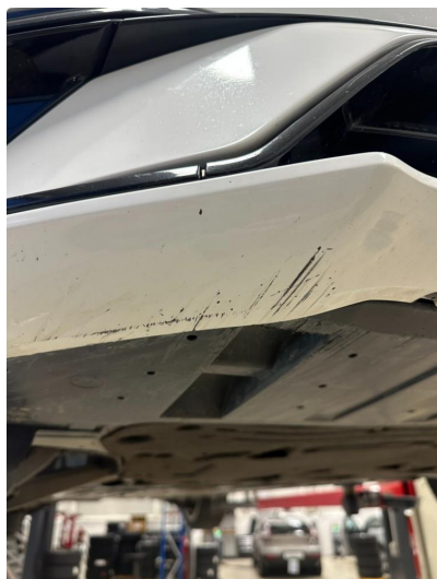
1.1 Noe oppriper på underside av fanger foran
