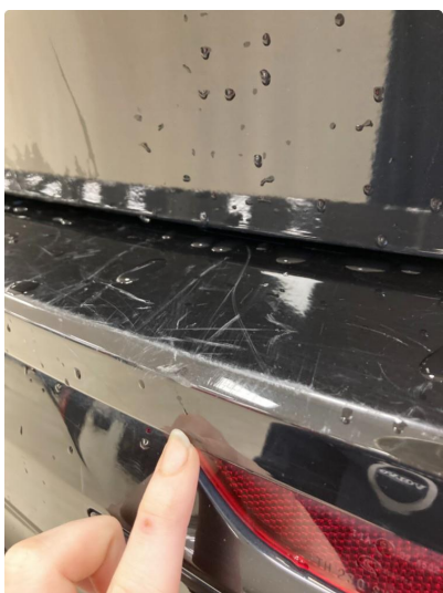
1.4 Noen lasteriper i fanger bak. Dempes med rubbing og polering
