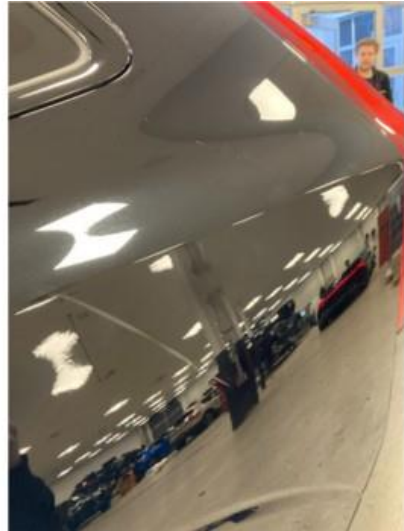
1.2 Ripe i skjerm høyre bak. Dempes med rubbing og polering
