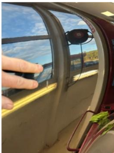
1.1 To små riper i dør høyre bak. Lakkeres forenklet
